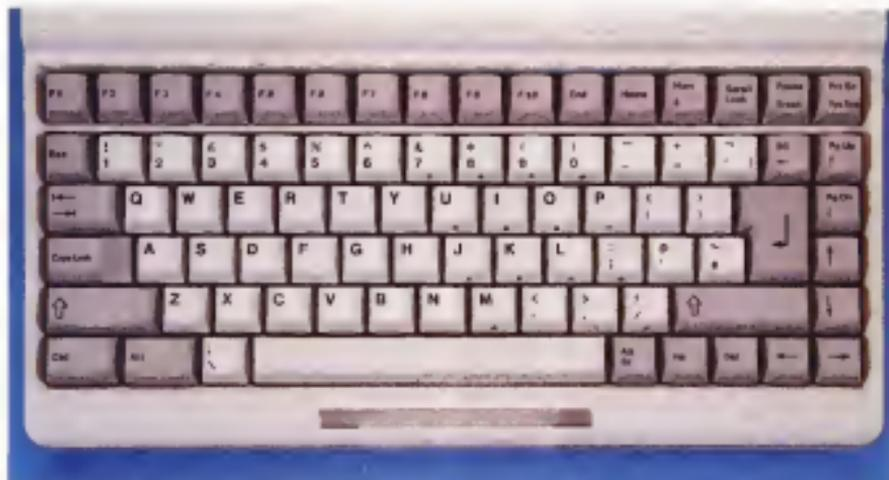
La tastiera del portatile Schneider con 87 tasti disposti ergonomicamente
